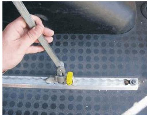
Posición manual de un anclaje sobre un raíl de un autobús o vehículo adaptado.
