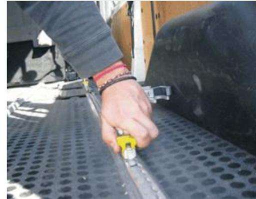
Anclaje colocado en el raíl de un autobús o vehículo adaptado, sujetando la rueda delantera de la silla de ruedas.
