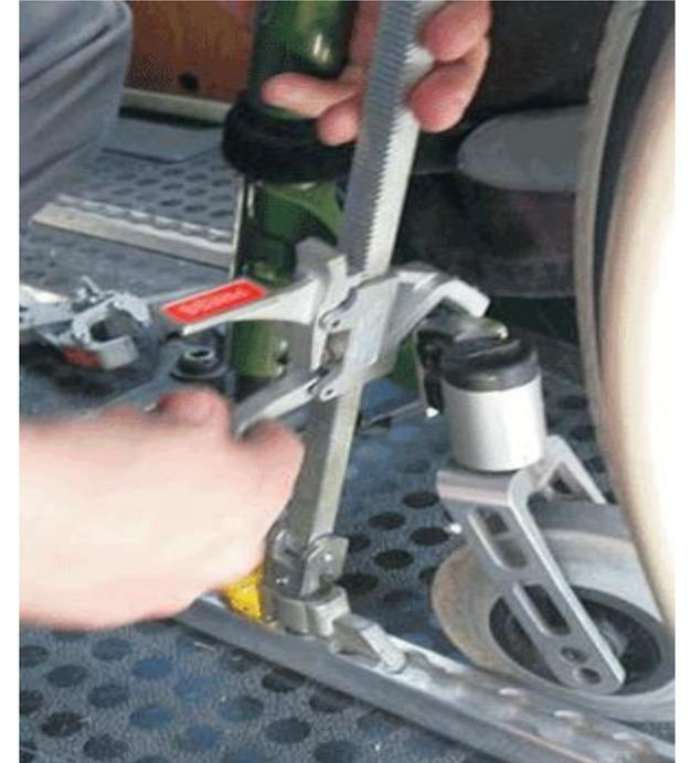
Posición del anclaje sujetando la rueda delantera de la silla de ruedas sobre el raíl del autobús o vehículo adaptado.
